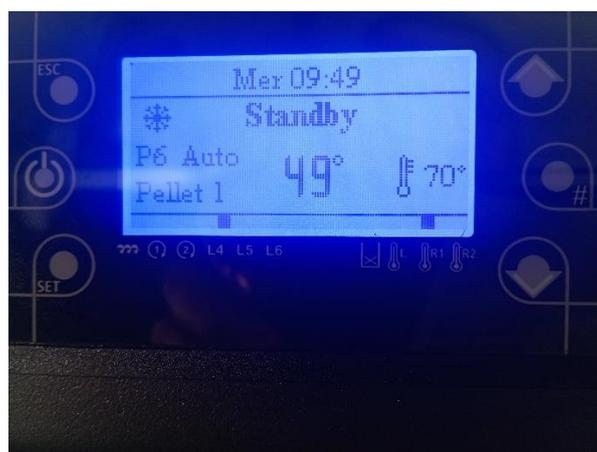
Al calare della temperatura rilevata rispetto alla temperatura impostata, la Termostufa riprenderà a funzionare in Normale.
