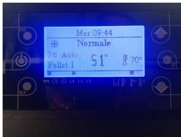
La fase Normale, durerà sino a che la temperatura dell'acqua in Termostufa non avrà raggiunto il valore impostato. Tale operazione, sarà contraddistinta dalla comparsa sul display della scritta Standby. In tal senso, vedere l'immagine sottostante:
