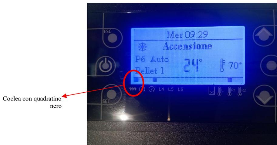
Ogni volta che si attiva la coclea e cade il pellet nel focolare, apparirà un quadratino nero posizionato sopra il simbolo della coclea.
