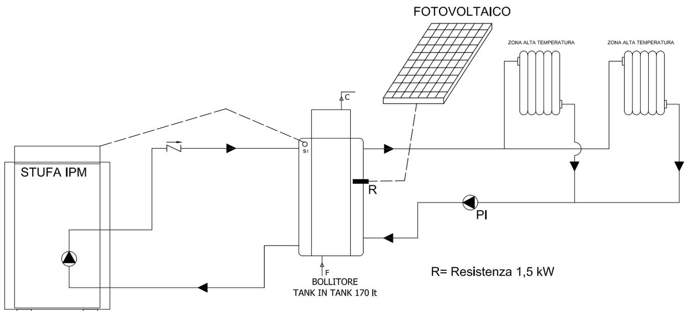
Quando gli spazi disponibili sono ridotti e non si può installare un puffer da 500 lt, l'opzione della IPM diventa l'unica possibile e definisce l'impianto.
