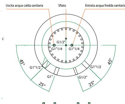
Pressione max d'esercizio serbatoio 3 bar/100°C
