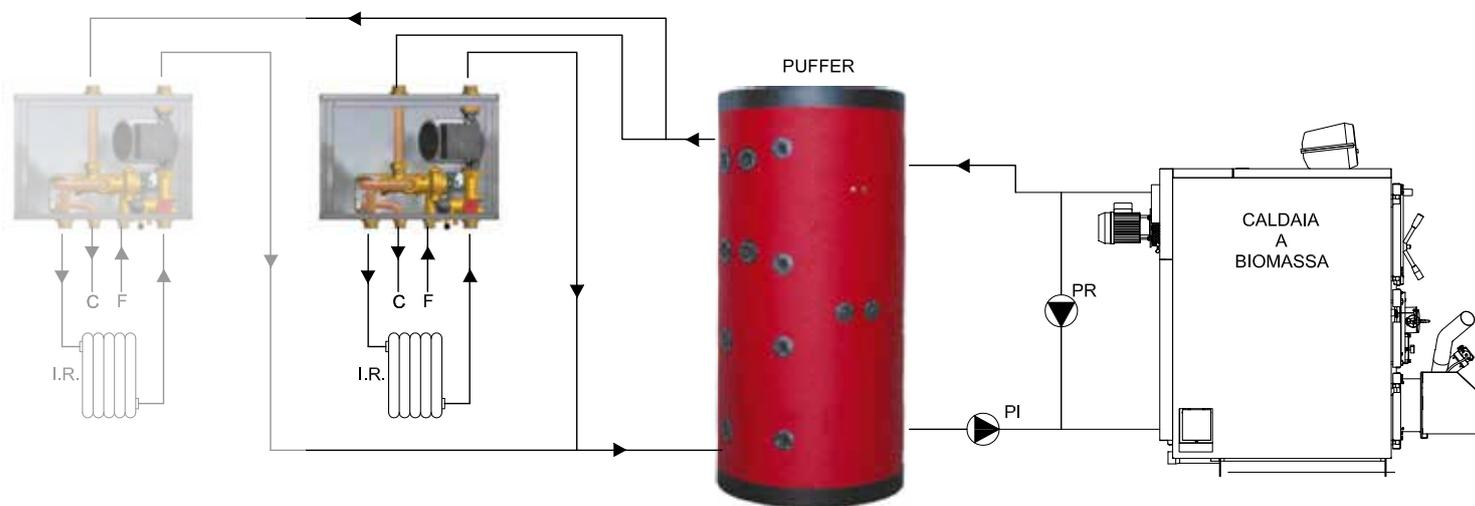
**Il sistema di produzione di acqua sanitaria composto da accumulo di acqua di riscaldamento abbinato a un produttore di acqua calda sanitaria istantaneo offre molti vantaggi per le applicazioni con caldaie a biomassa:**
