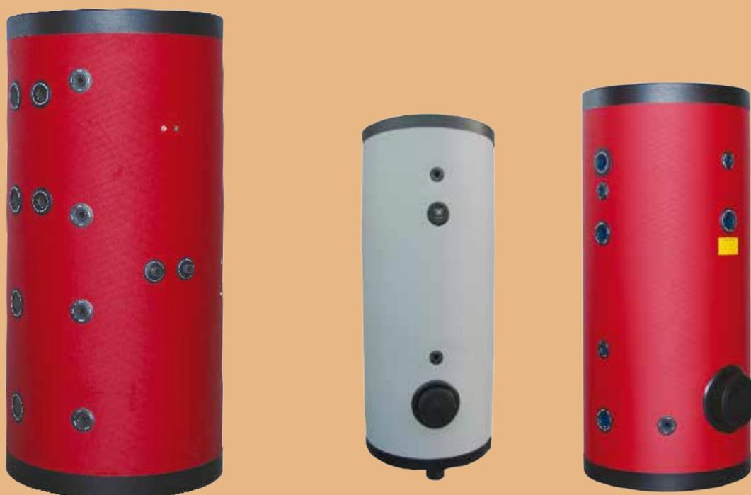
Gli accumuli da abbinare alle caldaie a biomassa richiedono in generale il rispetto della regola di 20 lt / kW per le caldaie a pellet e il disposto della EN 303-5 per le caldaie a legna (per queste ultime è necessario il calcolo del fabbisogno termico dell'edificio).
