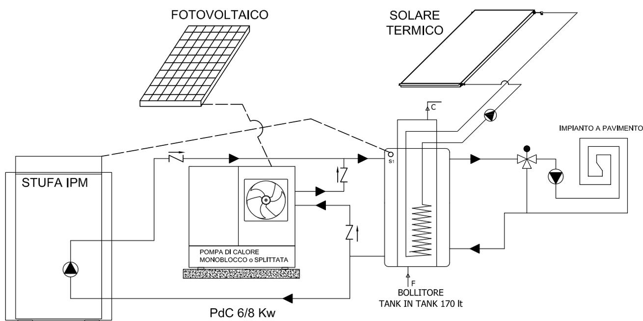
L'IPM in versione stufa idro (non c'è obbligo accumulo per norma, per cui si dimensiona al minimo il volume per la PdC e la IPM) affiancata da un accumulo da 170 lt che risulta ottimale sia per PdC che per IPM.
