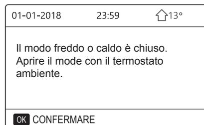
② Il termostato ambiente è IMPOSTATO UNA ZONA o DOPPIA ZONA (vedere "IMPOSTAZIONE TERMOSTATO AMBIENTE" nel "Manuale di installazione e uso"). Il termostato ambiente controlla la modalità di funzionamento ON / OFF dell'unità, è impostata sull'interfaccia HMI.
