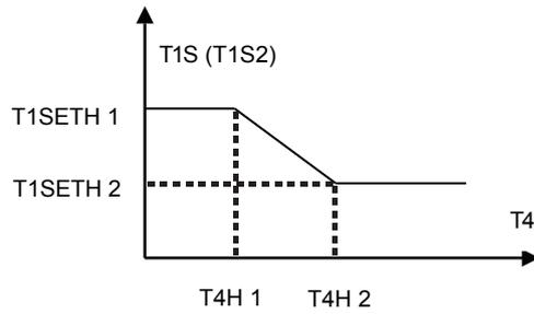
Stato: nell'impostazione dell'unità di controllo, se  $T4H2 < T4H1$ , scambiarne il valore; se  $T1SETH1 < T1SETH2$ , scambiarne il valore.
