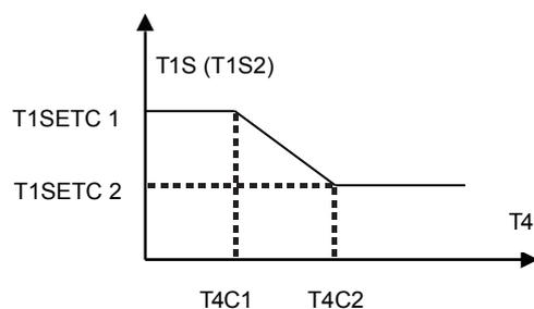
Stato: nell'impostazione dell'unità di controllo, se  $T4C2 < T4C1$ , scambiarne il valore; se  $T1SETC1 < T1SETC2$ , scambiarne il valore.
