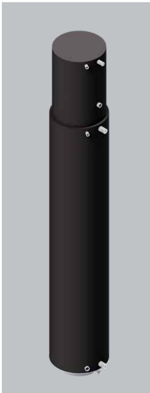
Bollitore sanitario in acciaio inox tank in tank: - 170 lt - altezza 1950 mm - ø 350 mm
