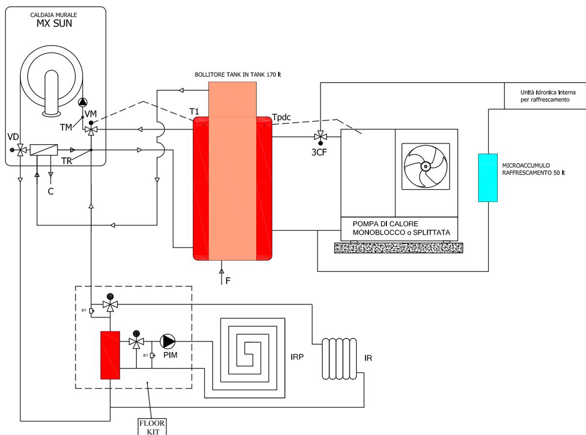
La logica di questo schema è che la caldaia murale a gas è utilizzata solo come soccorritore di ultima istanza, la PdC ha la priorità. In sostanza la caldaia murale funge da regolatore della distribuzione del riscaldamento e il sanitario viene prodotto dalla fonte rinnovabile.
