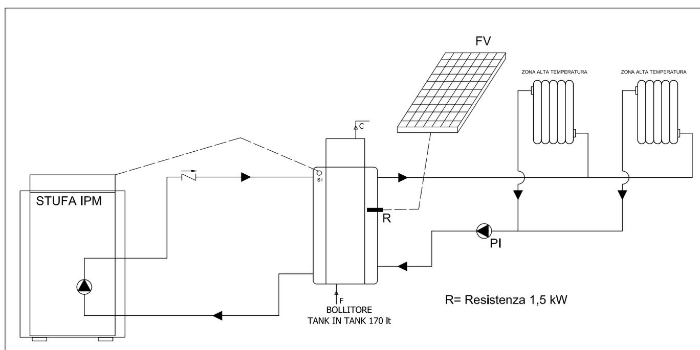
Quando gli spazi disponibili sono ridotti e non si può installare un puffer da 500 lt, l'opzione della IPM diventa l'unica possibile e definisce l'impianto.
