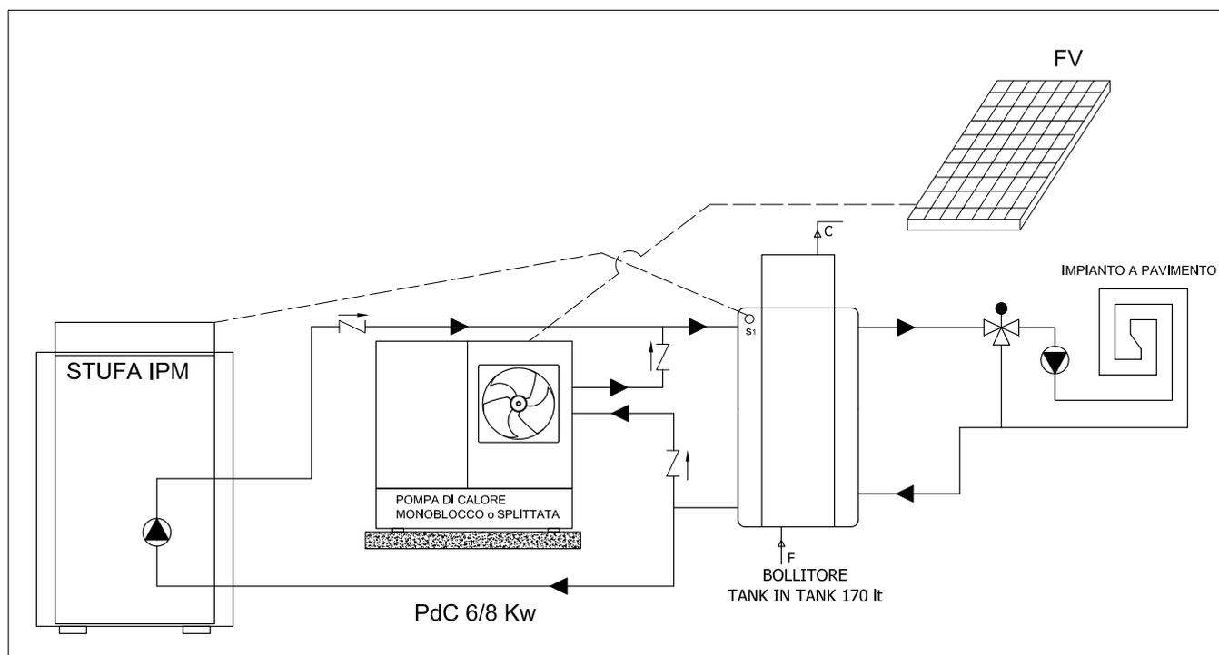
L'IPM in versione stufa idro (non c'è obbligo accumulo per norma, per cui si dimensiona al minimo il volume per la PdC e la IPM) affiancata da un accumulo da 170 lt che risulta ottimale sia per PdC che per IPM.
