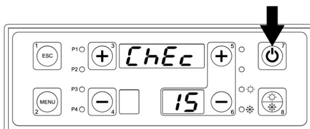
Nel momento in cui viene avviato il ciclo di funzionamento sul display superiore compare la scritta “CHEC” e parte il ventilatore alla massima velocità per effettuare una pulizia iniziale del bocchaglio del bruciatore a pellet. Questa fase ha durata di 2 minuti.
