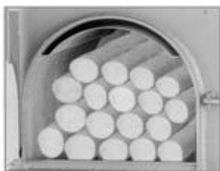
Formato il letto di braci si può procedere alla carica della legna. Aprire lentamente la porta del magazzino legna, per dare modo al ventilatore di aspirare i fumi accumulati nel magazzino legna. Per mezzo dell'attizzatore in dotazione, aprire lentamente la portina antifumo e distribuire uniformemente le braci sulla pietra principale. Si potrà poi procedere alla carica della legna, che dovrà essere effettuata con tronchetti della stessa lunghezza del focolare.
