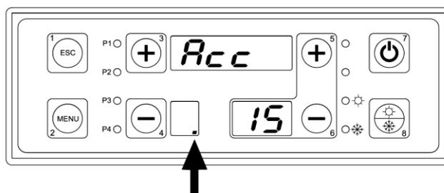
Questa è la fase di preriscaldamento della resistenza di accensione indicata da un punto sul display inferiore sinistro. Ha durata di 2 minuti e il ventilatore passa alla minima velocità.
