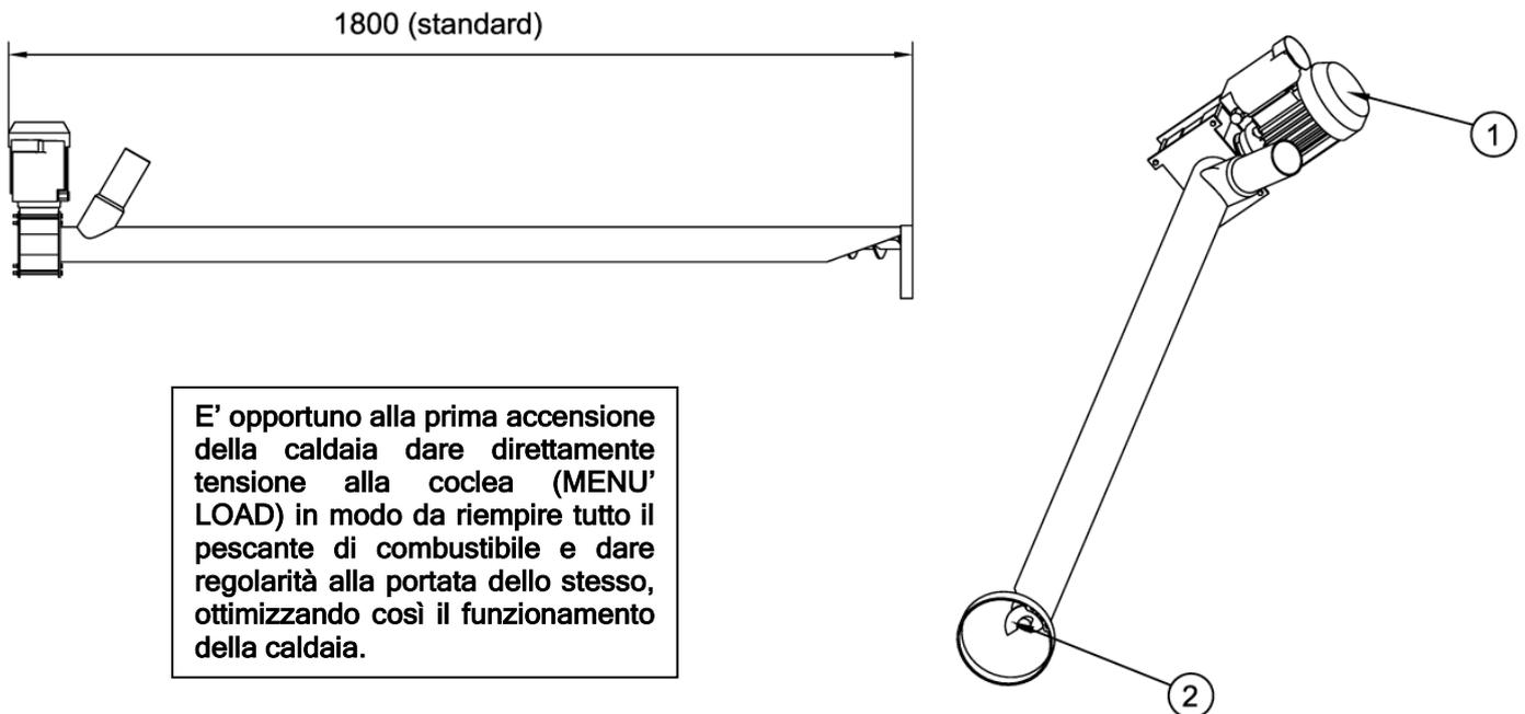
E' opportuno alla prima accensione della caldaia dare direttamente tensione alla coclea (MENU' LOAD) in modo da riempire tutto il pescante di combustibile e dare regolarità alla portata dello stesso, ottimizzando così il funzionamento della caldaia.
