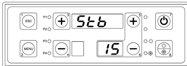
In questa fase la resistenza si è spenta, il ventilatore gira alla massima velocità e il motore coclea inizia a girare per caricare pellet nel bruciatore come da parametri impostati sulla scheda elettronica.
