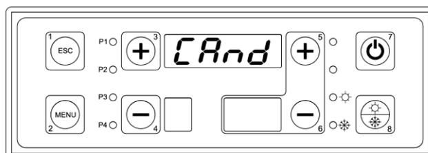
\* Il parametro **CAND** è da testare solo se è previsto il suo utilizzo ovvero su caldaie tipo Duo Tech, Duomatic, Triomatic o Granola automatica / manuale.
