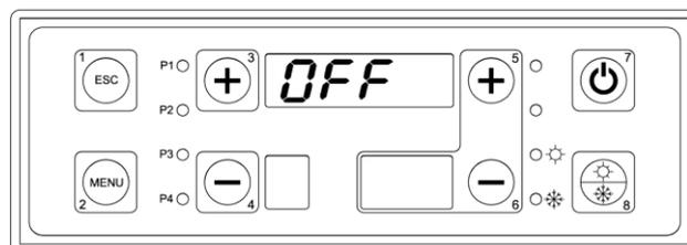
5) Premere i tasti n°3 o n°4 per portare la coclea in **ON**. Se non viene premuto il tasto **ESC** dopo 40 secondi la coclea si porta in **OFF** automaticamente.
