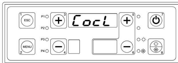
\* Il parametro **COCL** è da testare solo se è previsto il suo utilizzo ovvero su caldaie tipo Duo Tech, Duomatic, Triomatic o Granola automatica / manuale.
