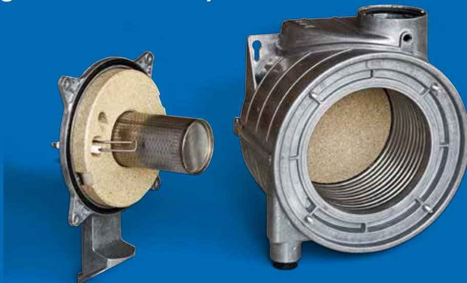
Lo scambiatore primario acqua-gas in acciaio inox è la migliore soluzione per i sistemi premiscelati in quanto costituito da un percorso monotubo in grado di avere limitate perdite di carico ed elevate portate idrauliche. Garantisce una funzionalità ottimale anche in presenza di impianti non
