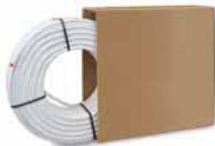
Tubo multistrato MULTYLAYER (PE-Xb/Al/PE-Xb conforme alle classi 1 - 2 - 4 e 5 della norma UNI-EN ISO 21003 e DIN 4726. Composto da un doppio strato interno ed esterno in polietilene reticolato PE-Xb (metodo B ai silani) legati tramite speciale adesivo ad uno strato intermedio in lega di alluminio saldato longitudinalmente (TIG testa a testa). Garantisce un alto livello di modellabili-
