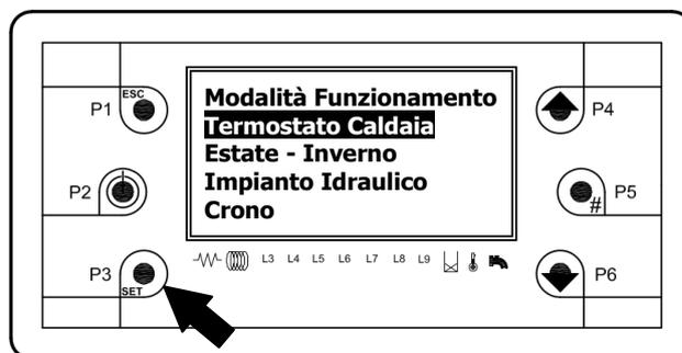
Tramite i tasti **P4** e **P6** si può evidenziare la voce di menù desiderata. Con il tasto **P3** si entra nel sottomenù evidenziato ottenendo la lista dei sottomenù o l'impostazione del parametro selezionato (Termostato Caldaia).
