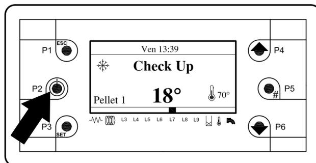
Nel momento in cui viene avviato il ciclo di funzionamento sul display superiore compare la scritta **“Check Up”** e parte il ventilatore alla massima velocità per effettuare una pulizia iniziale del boccaglio del bruciatore a pellet. Il led L7 è illuminato in quanto in questa fase è attiva la valvola aria per la pulizia del boccaglio del bruciatore (solo su modelli 14, 20, 30, 40 e 50). Questa fase ha durata di 2 minuti.
