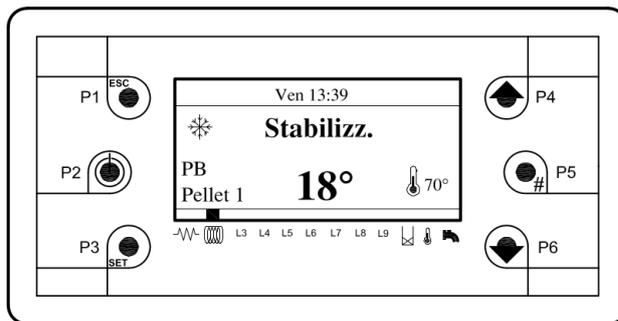
In questa fase la resistenza si è spenta, il ventilatore gira alla massima velocità e il motore coclea inizia a girare per caricare pellet nel bruciatore come da parametri impostati sulla scheda elettronica.
