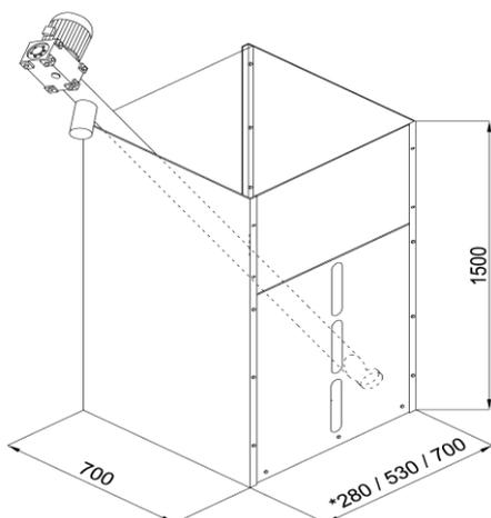
Il contenitore del pellet può essere fornito in tre diversi tagli di capacità:
