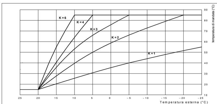
La régulation de la température milieu peut arriver en utilisant la compensation seule de la température d'envoyée avec la température extérieure ou en combinaison avec le lointain. La correction de la température chauffage est effectuée avec cadence une minute avec une fonction de réduction des variations soudaines.
