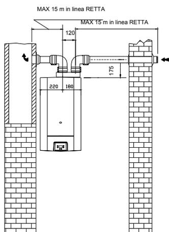
N.B La somme de la longueur du tube d'évacuation plus la somme de la longueur du tube d'aspiration ne doit pas dépasser 30 m.
