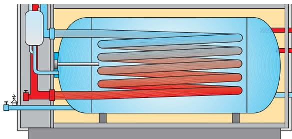
La struttura del THERMOUNIT dispone di un telaio di supporto caldaia indipendente. Il bollitore risulta quindi estraibile senza necessità di interventi sull'impianto o sulla caldaia stessa. Lo scambiatore del bollitore, grazie alla geometria rettangolare dello sviluppo può essere svuotato completamente, quando le esigenze di fermo impianto per lunghi periodi in zone particolarmente fredde comportano rischi di congelamento.
