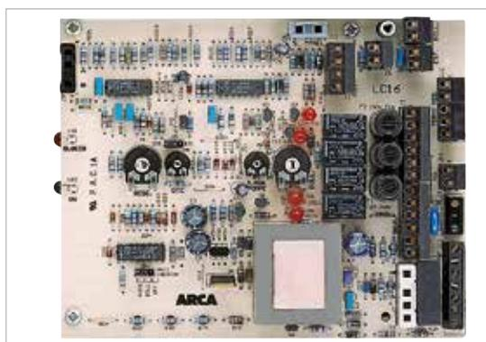
Tutte le funzioni della caldaia, (controllo temperature, termoregolazione automatica, post circolazione), del bruciatore (accensioni e spegnimenti), del bollitore (precedenza), vengono governate da una scheda elettronica dotata di circuiti integrati. I tempi di risposta sono rapidissimi e la precisione di intervento delle sonde di temperatura risulta estremamente elevata, grazie all'eliminazione dei tradizionali termostati di regolazione a bulbo.
