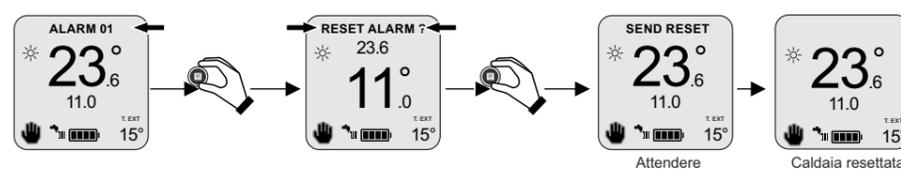
Nota: "RESET ALARM?" è visualizzato solo per la anomalie sbloccabili
