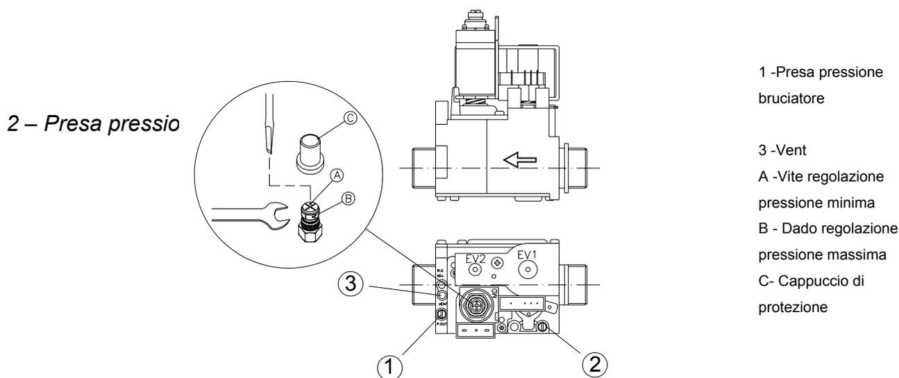
Per eseguire il controllo delle pressioni al bruciatore, inserire le sonde del manometro nelle prese di pressione disponibili sulla valvola gas (vedi fig.).
