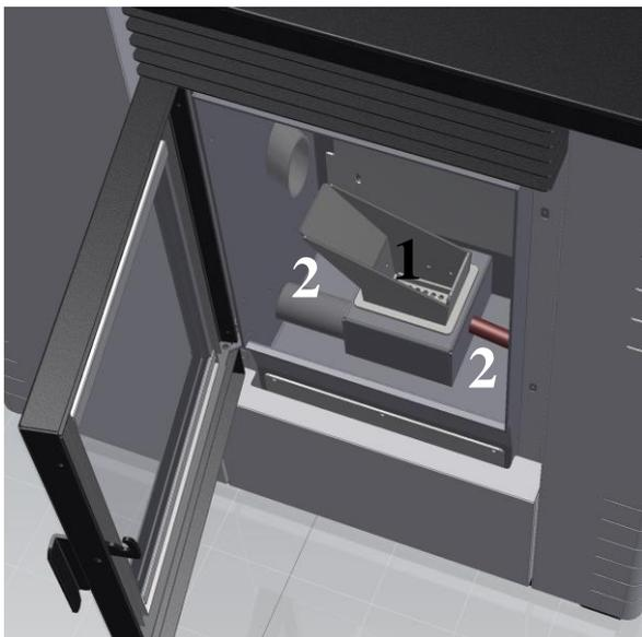
Aspirare dal vano cenere principale (2) le polveri e le ceneri della combustione, utilizzare un aspiratore tipo Bidone con filtro.
