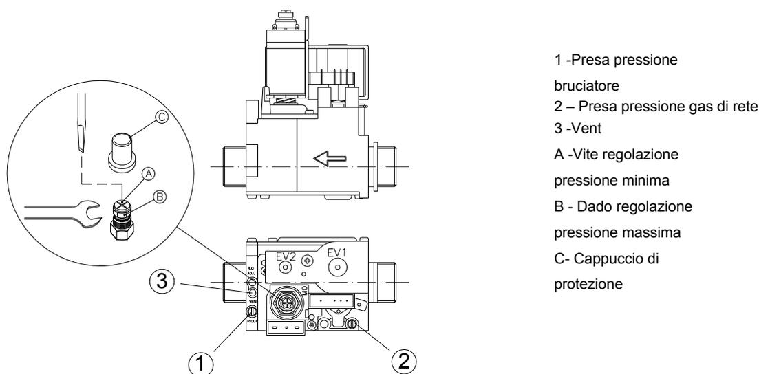
Per eseguire il controllo delle pressioni al bruciatore, inserire le sonde del manometro nelle prese di pressione disponibili sulla valvola gas (vedi fig.).
