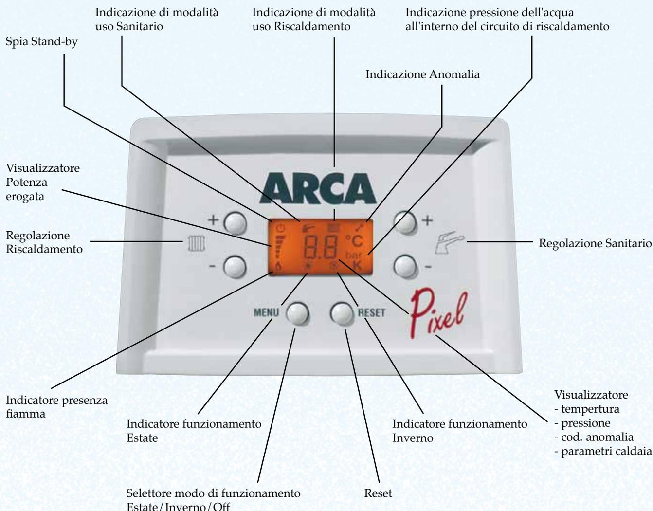
La massimizzazione delle prestazioni e quindi la riduzione dei consumi, richiede, oltre a un'elettronica intelligente, la dotazione di una **sonda esterna** che consente in qualunque condizione di impianto la temperatura minima di funzionamento per esaltare le doti condensanti della caldaia che nelle stagioni intermedie raggiunge rendimenti prossimi al valore tabellare.
