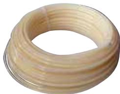
Materiale: Tubazione per riscaldamento e raffreddamento a pavimento in polietilene reticolato PEX ad alta densità PE-XA, conforme EN ISO15875, realizzato con barriera anti diffusione dell'ossigeno in EVOH costruito secondo DIN 4726 a tre strati; è certificato con codice identificativo AENOR 001/640.
