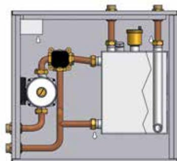
Cassetta di miscelazione **automatica** (con funzione climatica) con puffer.
