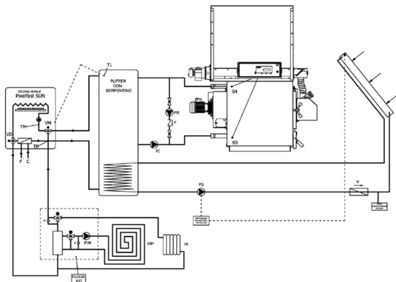
Schemi idraulici per sistemi complessi. In presenza di caldaia murale e fonte solare o biomassa, Arca dispone di un innovativo sistema brevettato ad elevata efficienza: il sistema SUN. Per ulteriori dettagli dello schema SUN visita il sito [www.arcacaldaie.com](http://www.arcacaldaie.com)
