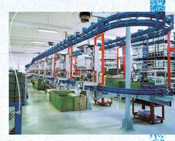
Linea automatica di assemblaggio caldaie murali S. Rocco al Porto (LO)
